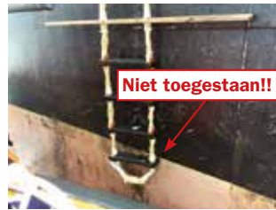
1 – Gevaarlijke lus aan onderkant ladder
