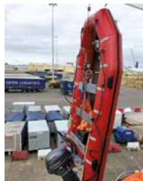
Reddingsboot – hangend in verticale positie omdat de banden niet correct zijn bevestigd
