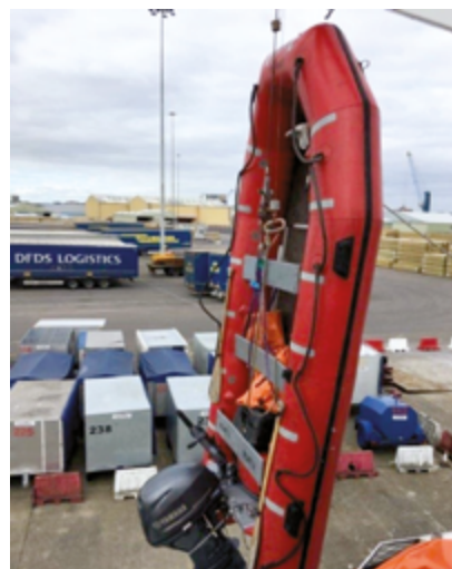
Rescue boat – nakabitin patayo dahil sa strops na hindi na wastong naikabit
