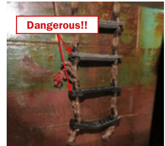
4 – Bent step at tripping line sa ibaba ng spreader
