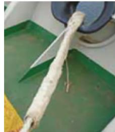
当通过巴拿马导缆孔带缆时，用帆布包裹缆绳防止磨损。
