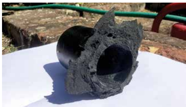
Litrato ng isang failed casting
